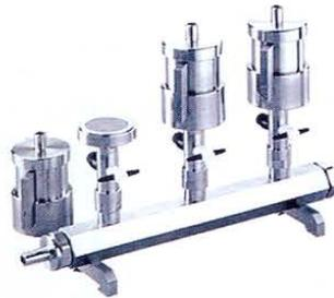
Filtraciona jedinica sa tri mjesta sa hermetički zatvorenim držačima filtera, od nehrđajućeg čelika. Držači filtera su za bazu povezani klizajućim čašicama, tako da se lako mogu vaditi. Također je moguća kombinacija držača filtera promjera 50 i 80 mm. Zahvaljujući svojim malim dimenzijama, držač filtera je veoma pogodan za rad u sigurnosnim radnim komorama - laminarima.
