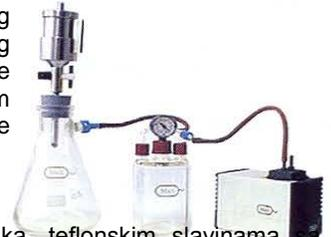
Držači filtera su opremljeni fritovima od nehrđajućeg čelika, teflonskim slavinama sa podešavanjem koje se ne moraju održavati. Lijeveći za filtere sa poklopcima su od 100 ili 600 ml. Boca za usisavanje kao i Vulfova boca imaju zaštitni sloj PVC-a. Vakum pumpa je napravljena za neprekidnu upotrebu, a također može proizvoditi i komprimovani zrak. Svaki dio opreme je moguće dobiti zasebno.
